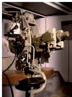
Canon antichar de 9 cm sur affût à flasques au Fort de Litroz. Ce canon barrait l'axe routier au niveau du virage de Tête-Noire et interdisait l'accès en direction de Trient, en combinaison avec un ouvrage miné et une barricade antichar.
