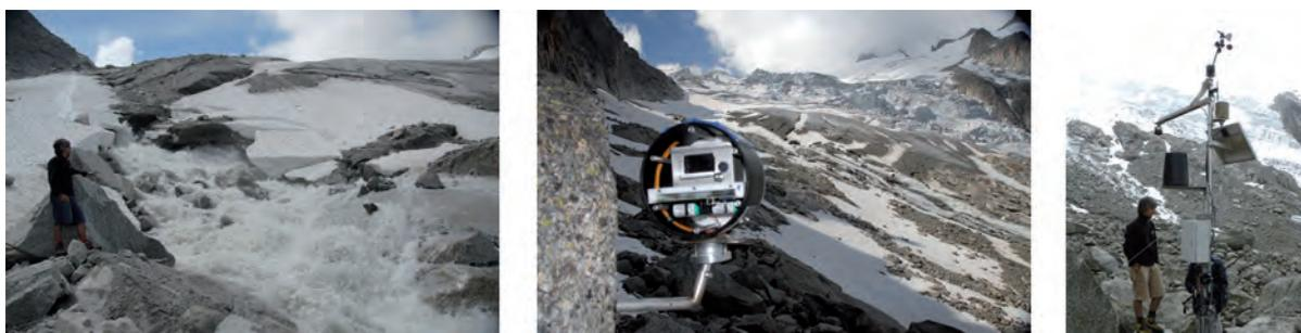
Photo 14 à 16 : Surveillance de la Tine sortant du névé des Ecardies avec Appareil photo automatique et station météo à 2550 m, posé en juillet 2010 (gaiasens.com) (cl. L. Moreau).
